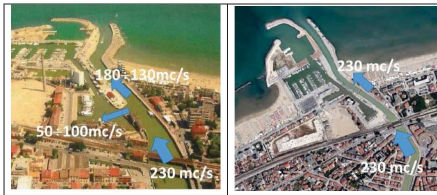
Figura 110. Il nodo idraulico prima (sin) e dopo l'esecuzione dei lavori della darsena (dx).
