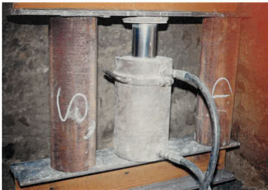
Fig. 6 – particolare martinetto e telaio di contrasto
