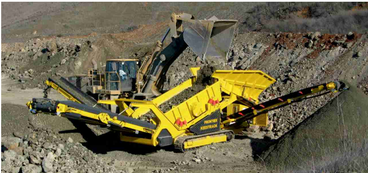
Fig. 4.3: impianto mobile di vagliatura Keestrack Frontier 4518-S
